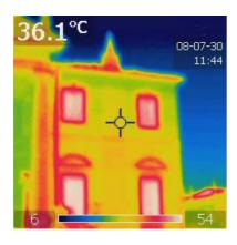
Gli elementi lapidei della facciata sono messi in evidenza, dato il loro diverso grado di riscaldamento rispetto al resto della struttura.
